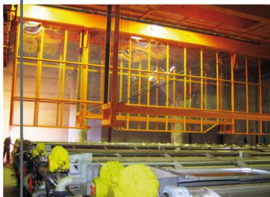
Chaîne de phosphatation grandes dimensions (module 18m, charge 8T)
