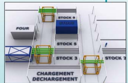
Synoptique d'une chaîne de laquage
